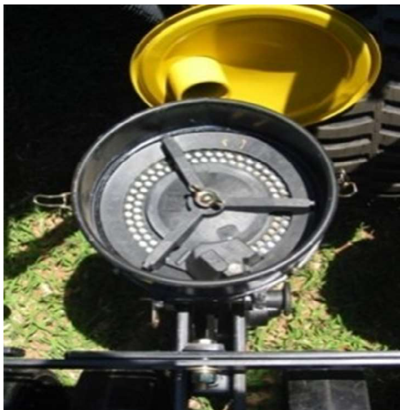
Disco de distribuição de semente horizontal com mecanismo dosador de sementes. Fonte: (SILVA, 2015).
